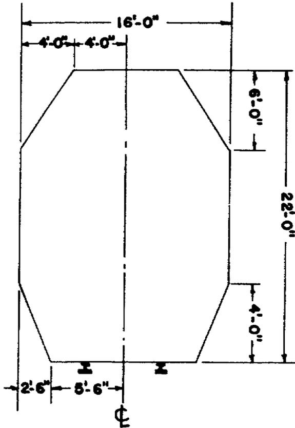
CLEARANCE DIAGRAM FOR SINGLE-TRACK TUNNEL TRACK ON TANGENT
