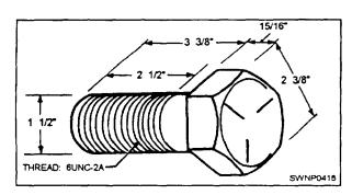
Figure 10-8.—An A6B assembly bolt.
